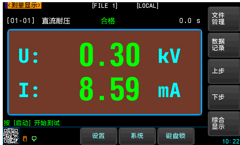
图 6-3 直流耐压测量界面
