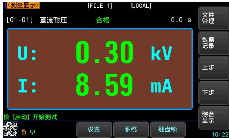
图 6-3 直流耐压测量界面
