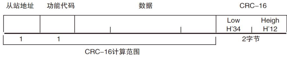
图 11-2 Modbus 附加 CRC-16 值
