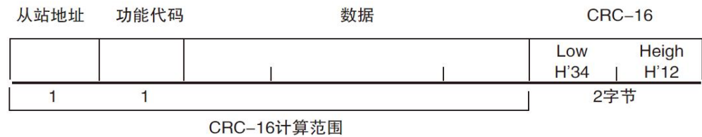
图 11-2 Modbus 附加 CRC-16 值
