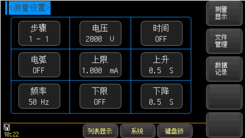
图 4-2 交流耐压测试参数设置页
