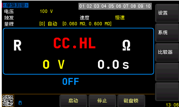
图 6-2 测试线全部接触不良
