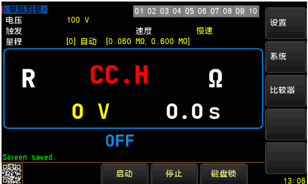
图 6-3 HIGH (+) 端测试线接触不良
