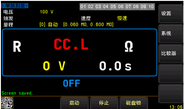
图 6-4 LOW (-) 端测试线接触不良
