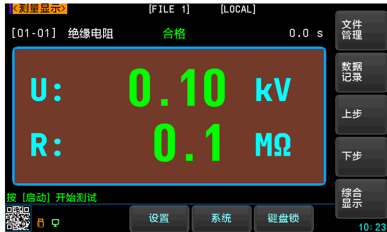
图 6-4 绝缘电阻测试界面
