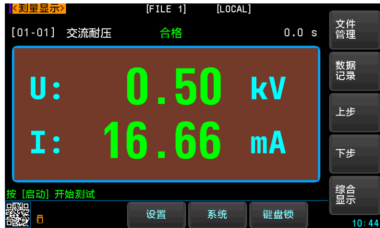
图 6-2 交流耐压测量界面
