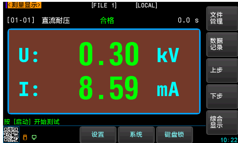
图 6-3 直流耐压测量界面
