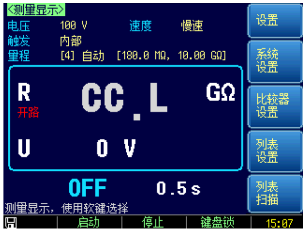
图 5-5 LOW (-) 端测试线接触不良
