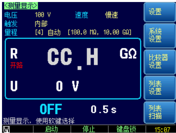
图 5-4 HIGH (+) 端测试线接触不良
