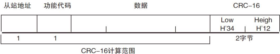
图 9- 1 Modbus 附加 CRC-16 值
