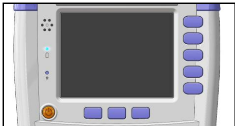
图 3-3 充电指示灯，充电时显示为橙色
