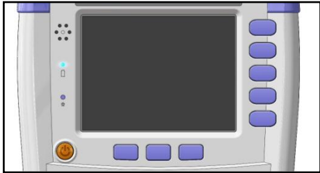
图 3-3 充电指示灯，充电时显示为蓝色
