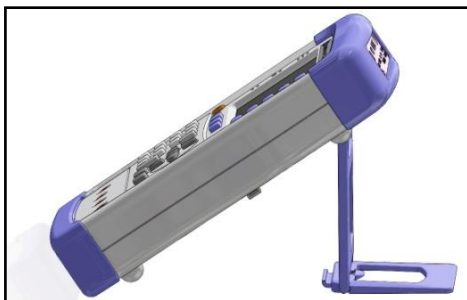
图 1-3 45 度时的支撑位置
