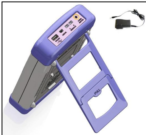
图 3-2 外部电源适配器与仪器连接
