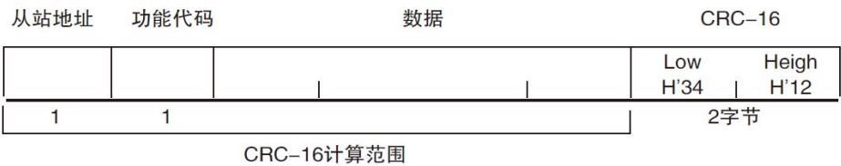
图 9- 1 Modbus 附加 CRC-16 值
