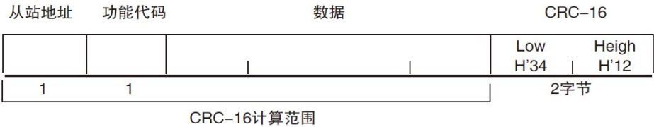
图 9- 1 Modbus 附加 CRC-16 值
